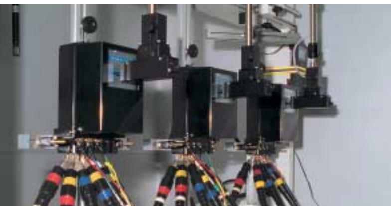
1: Das Laboratorium für elektrische Energie am METAS prüft Elektrizitätszähler und ihre Zusatzeinrichtungen. Ermächtigte Eichstellen sorgen für die Eichung eines jeden im Elektrizitätsnetz zu Verrechnungszwecken eingesetzten Messinstrumentes.
