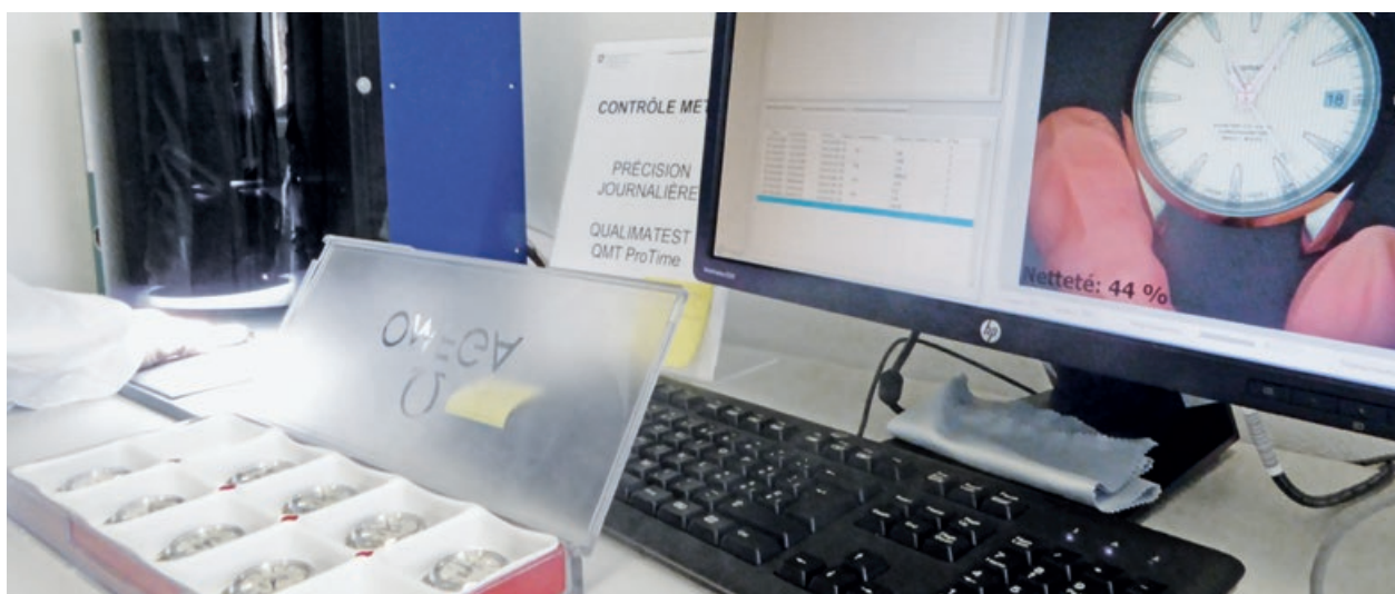
2: Mesure de la précision journalière par un système de vision – appareil Qualimatest Prottime.
