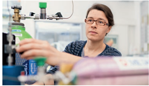
4: Apparatur für dynamisches Verdünnen: Um die Atmosphären-Konzentration (wenige ppt) der Referenz zu erreichen, verdünnt Dr. Myriam Guillevic das Gas aus der Stahlflasche mit hochreiner Luft.
