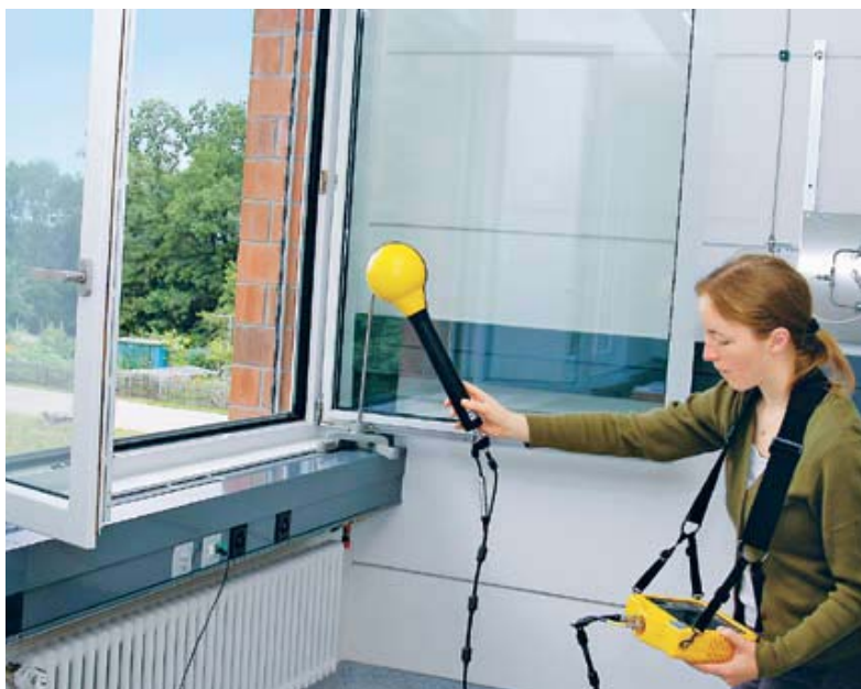
6 Personnel de mesure effectuant un balayage systématique du volume de mesure.
