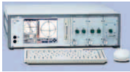
4: Polarimètre permettant l'analyse temporelle des propriétés de polarisation d'éléments à fibres optiques.
