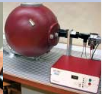
7: Das Kugelphotometer im Photometrie-Labor liefert den Reflexionsgrad von spiegelnden Folien für Fahrzeugfenster.
