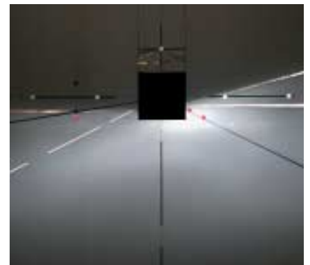
2: Lichtkegel eines asymmetrischen Abblendlichts, projiziert auf Scheinwerfer-Einstellwand.
