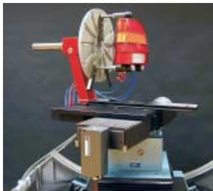
1: Goniometer mit eingespannter Heckleuchte als Prüfobjekt.
