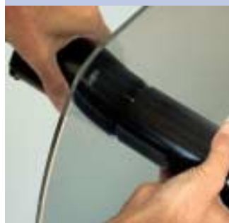
6: Mit einer mobilen Messeinrichtung bestimmt METAS den visuellen Transmissionsgrad von Fahrzeugfenstern.
