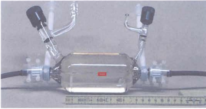
3: Glasgefäß mit Thermistorsonden.
