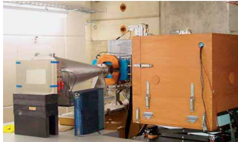
2 Das METAS-Wasserkalorimeter (rechts) neben dem Protonenstrahlaustritt (links) im Testareal der PROSCAN-Anlage des PSI.
