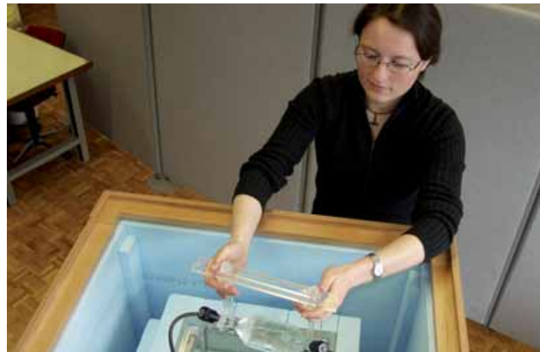
3 Innenleben des METAS-Wasserkalorimeters: ein geschlossenes Glasgefäß mit ultrareinem Wasser in einem gekühlten und thermisch isolierten Wasserphantom.
