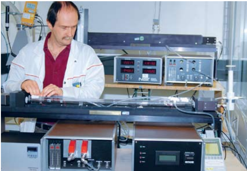
2 Das nationale Ozon-Normal des METAS ist ein hochempfindliches Ultraviolett-Photometer (Standard Reference Photometer, SRP) mit der Bezeichnung SRP14.
