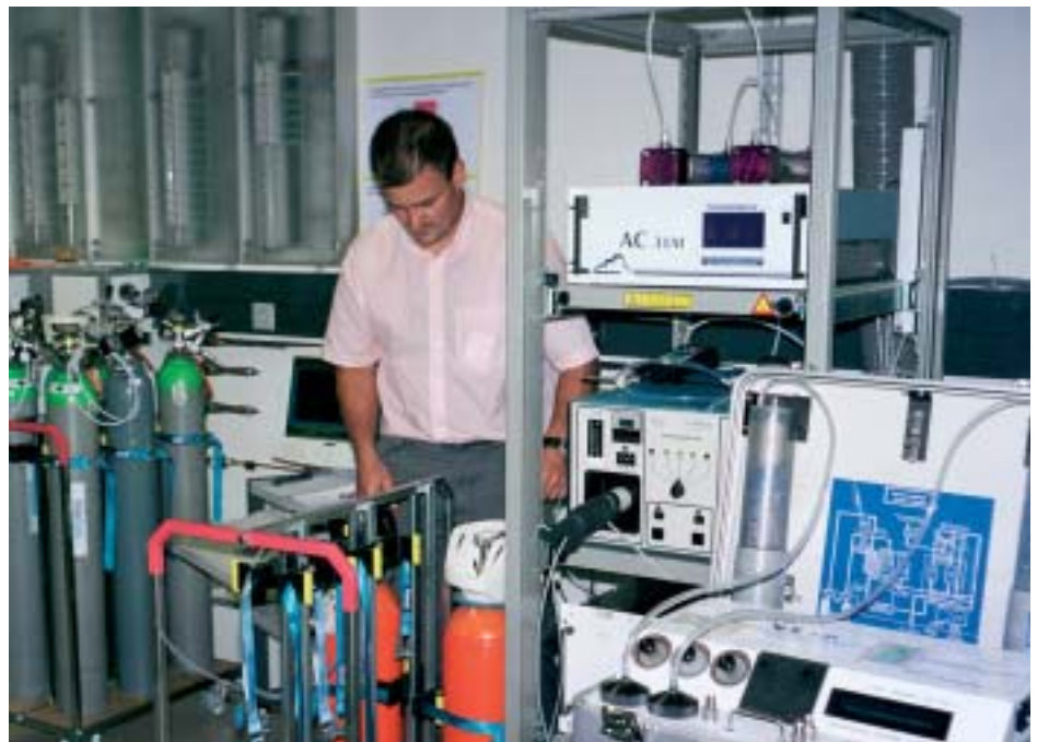
1: Die Rückverfolgbarkeit von Immissionsmessgeräten erfordert einen erheblichen apparativen Aufwand. Hier wird ein tragbarer Permeationsofen (rechts) mit dem Laborstandard verglichen.
