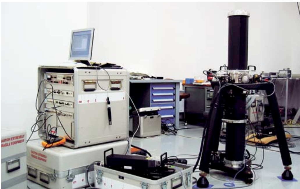
2 : Le gravimètre absolu de type FG5 de METAS.
