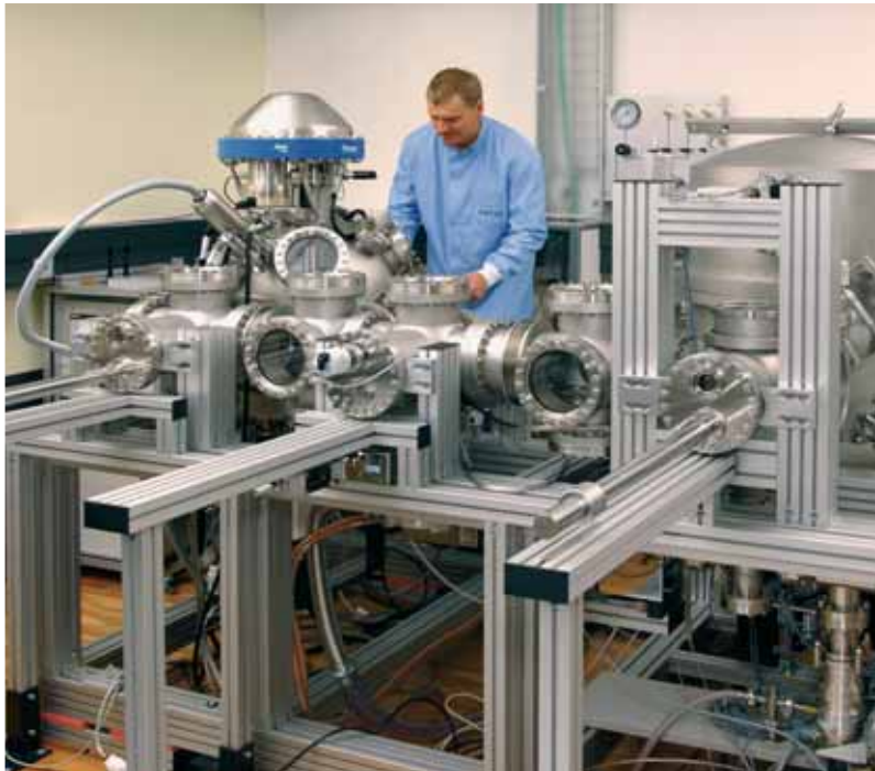
z: Projekt «Kombinierte Methoden»: Die Messkammer zur Oberflächenanalyse («Pilz» links mit blauem Band) ist mit dem 1 kg-Vakuumpkomparator (Kammer rechts) verbunden.
