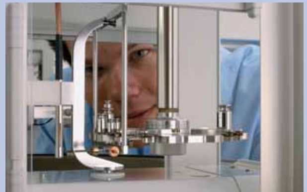
3: Vergleich eines 20 g Gewichtsstückes (rechts) mit einem Stapel von Gewichtsstücken, zusammengesetzt aus 10 g + 5 g + 2 g + 2 g + 1 g (links).
