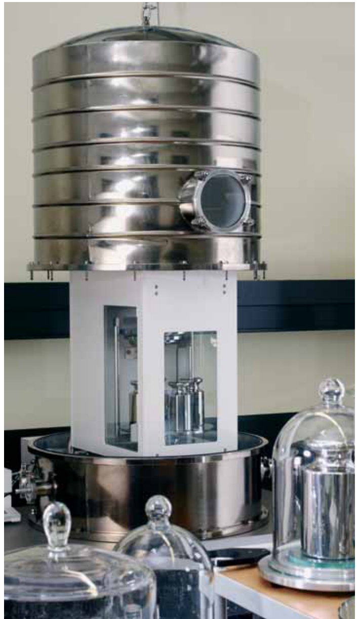
2: Der Druckbehälter des 10 kg-Komparators besteht aus Titan-Stahl und stammt aus St. Petersburg.
