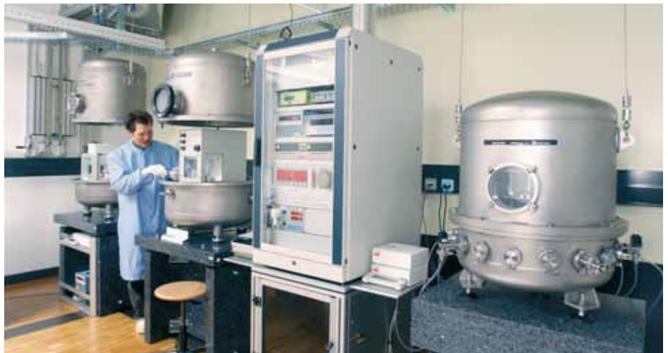
1: Drei in Druckkammern installierte Massekomparatoren für die Massebestimmung von 10 g bis 1 kg. Der Turm mit den Messgeräten dient zur genauen Bestimmung der Luftdichte in den Druckkammern.
