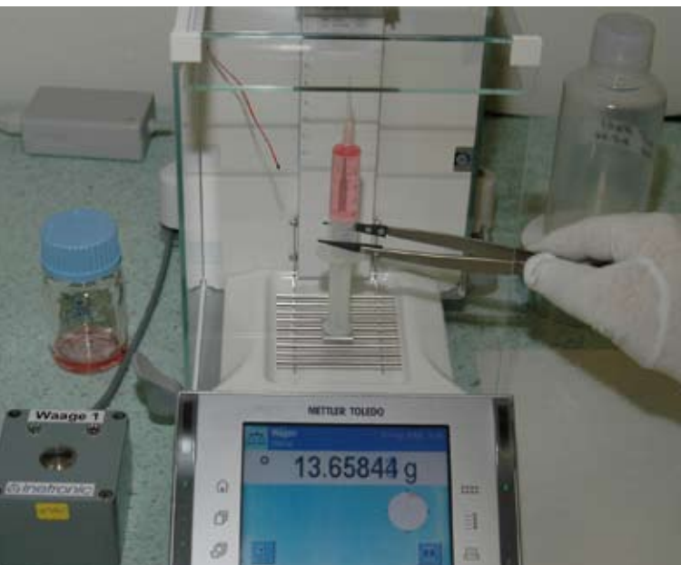
6 «Spritzen-technik» zur gravimetrischen Herstellung von Flüssigkeitsgemischen für Kalibrationszwecke.
