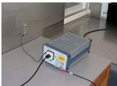
c: Kurze Masseverbindung zum Erdanschluss an der Vorderseite der Netznachbildung (40 cm)
