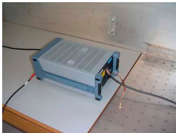
b: Kurze Masseverbindung zum Erdanschluss an der Rückseite der Netznachbildung (15 cm)
