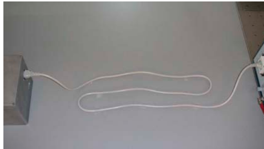
b: Mäanderförmig gebündeltes Netzkabel
