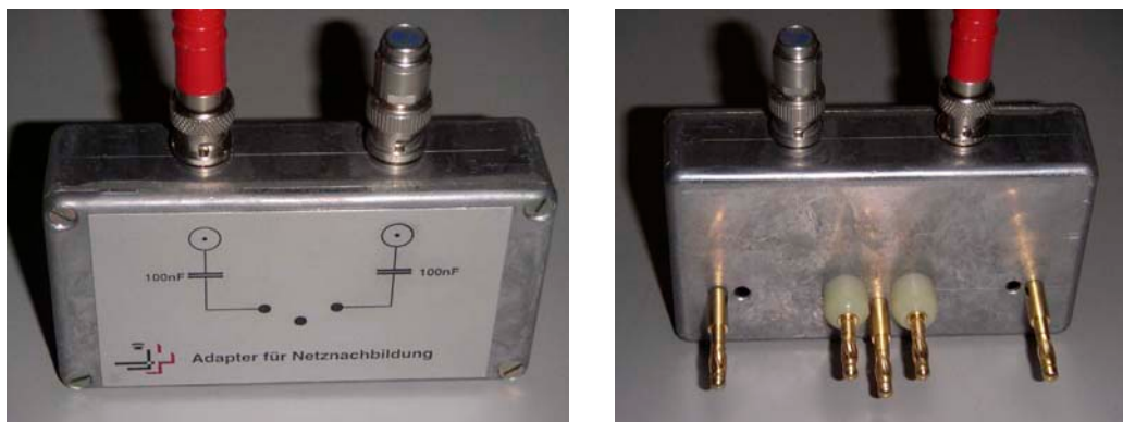
Fig.3: Adapter für die Einkopplung der Störquelle direkt an der Netznachbildung (Zusatzmessung 2)
