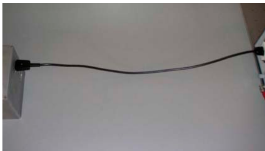
a: Auf 80 cm gekürztes Netzkabel (Referenz)
