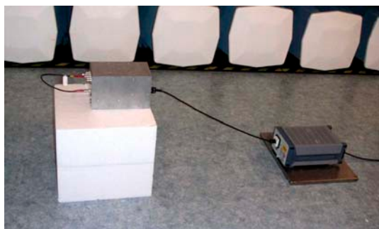
Fig. 34 Aufstellung für die Referenzmessung in der Absorberhalle mit Metallboden
