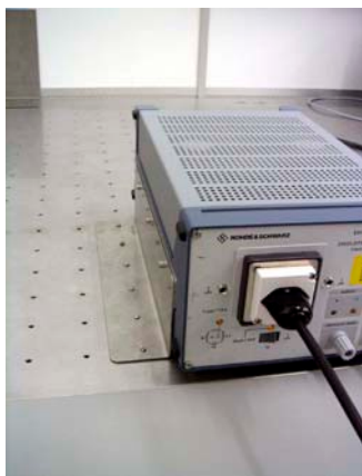
a: Referenzmessung Netznachbildung mit Blechwinkel an Metallplatte
