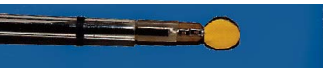
1 Étalon de transfert : La partie sensible au champ électrique (en jaune) a un diamètre de 1 cm.
