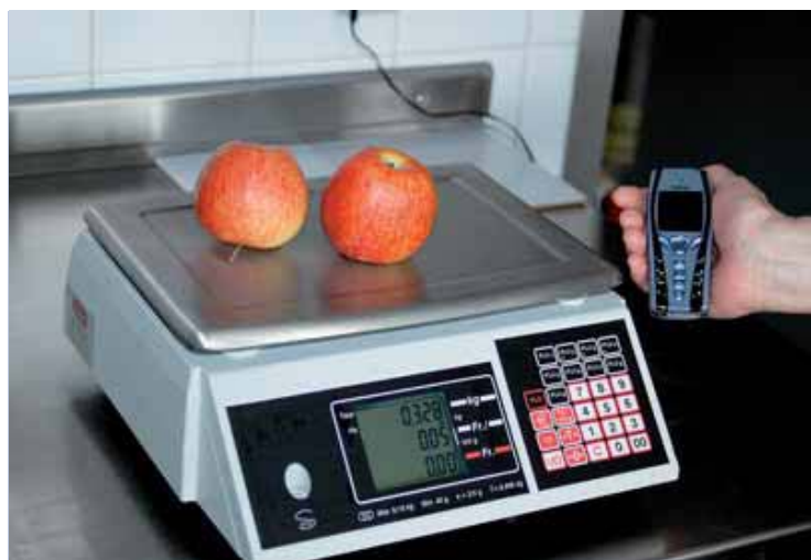
1 Der Einfluss elektromagnetischer Strahlung auf elektronische Messgeräte, beispielsweise von Mobiltelefonen auf Waagen, ist bekannt.
