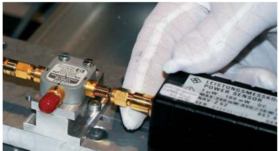
1: Die Kontaktierung der HF-Stecker muss mit viel Fingerspitzengefühl erfolgen.
