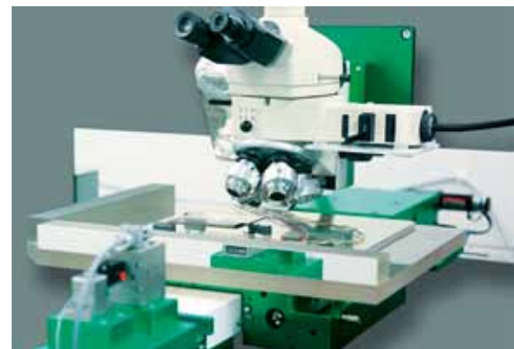
Photomaschinen-Messmaschine im Reinraum des METAS. Machine à mesurer des photomasques en salle blanche de METAS. Macchina di misurazione di fotomaskere nella camera bianca di METAS. Photomask measuring instrument in the METAS clean room.
