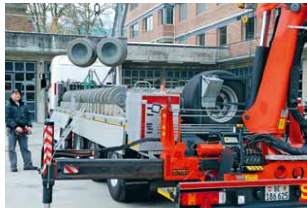
3 METAS-Cert unterhält zwei Prüflastwagen mit je 44 kalibrierten Gewichtsstücken à je 500 kg. METAS-Cert setzt diese Lastwagen für Prüfungen von Grosswaagen nach Modul F und für Kalibrierungen ein, vermietet sie aber auch an die kantonalen Eichämter und an Hersteller, die nach Modul D zertifiziert sind. Die Eichmeister führen Nacheichungen von Grosswaagen durch; die nach Modul D zertifizierten Hersteller setzen diese Lastwagen für das Inverkehrbringen von Grosswaagen ein.
