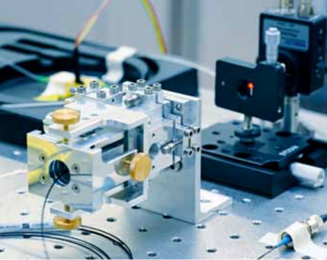
Die Lichteinkopplungsvorrichtung als Teil des optischen Positionierungssystems. Tête d'injection faisant partie du système de positionnement optique. Testa di iniezione, parte del sistema di posizionamento ottico. The injection head as a part of the optical positioning system.
