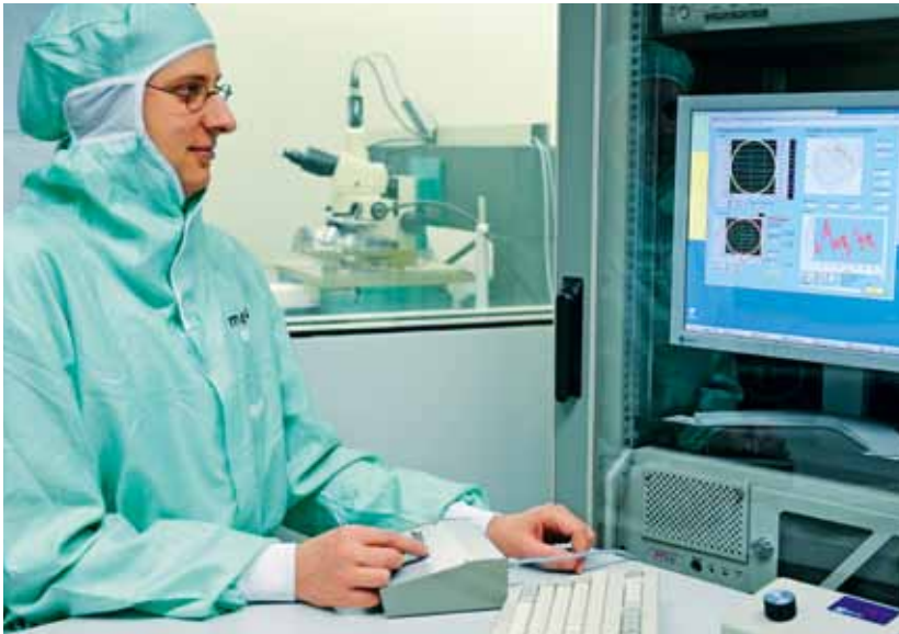
2 Die Glasmassstäbe wurden im METAS auf der optischen Photomasken-Messmaschine gemessen, die sich in einer Reinraumkabine der Klasse 100 befindet.
