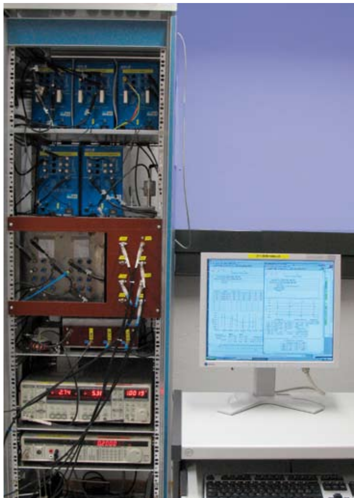
4 Pont coaxial automatisé de rapport 10:1. Ce pont permet l'étalonnage des condensateurs de précision de 1 pF à 100 nF à la fréquence de 1233 Hz et de 1 kHz.
