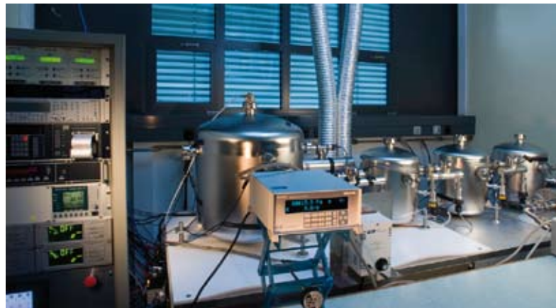
1 Système de détente statique utilisé pour la définition de la pression absolue de 10 \mu Pa à 100 Pa.
