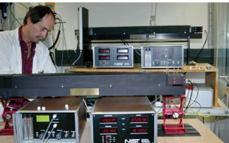
1 Messvergleiche von Ozonnormalen im METAS: Im Vordergrund befindet sich eines der fünf umgebauten Ultraviolett-Photometer (Standard Reference Photometer, SRP), im Hintergrund das Referenzgerät SRP0 des National Institute of Standards and Technology (NIST).
