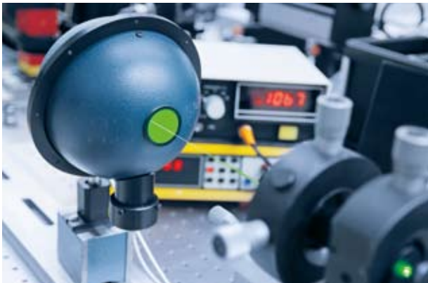
7 Mit Hilfe des SYLAC lassen sich eine Vielzahl unterschiedlicher optischer Empfänger charakterisieren und kalibrieren: Im Bild eine Ulbrichtsche Kugel.
