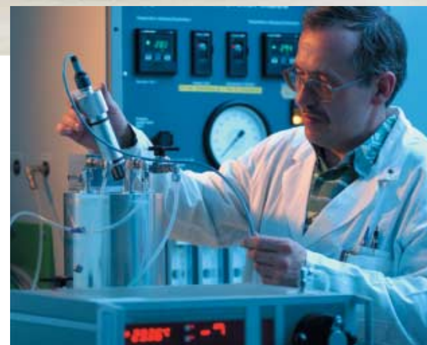
METAS kalibriert hoch genaue Feuchtemessgeräte für den Taupunktbereich von -85 °C bis +85 °C (Output) für Kalibrierstellen und Unternehmen mit hohen Genauigkeitsansprüchen. Diese benötigen solche Referenzmessmittel, um Betriebsmessmittel zu kalibrieren (Impact), die bei der Herstellung gasisolierter Schaltanlagen zur Kontrolle der Gasfeuchte benötigt werden. Solche Anlagen stellen die Energieversorgung der Gesellschaft sicher (Outcome).
