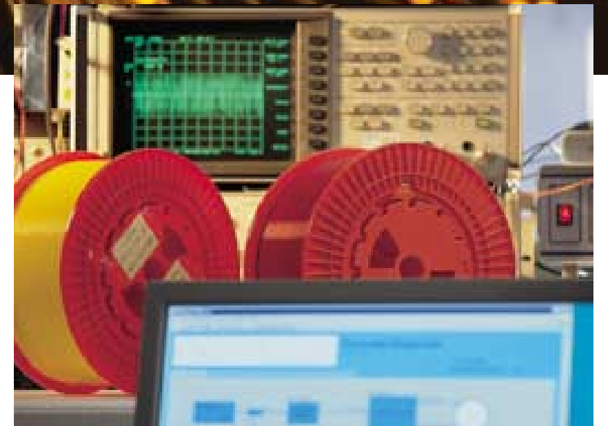
In questo nuovo posto di misurazione, si misura la dispersione cromatica di fibre ottiche.
