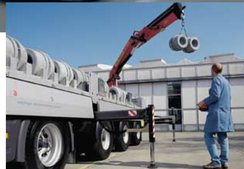
Il nuovo autocarro, utilizzato dal METAS per verificazioni ed entrato in servizio nell'ottobre del 2001, dispone di 44 pesi di verifica di 500 kg ciascuno e ha un peso proprio di ca. 17.7 t. Con tale autocarro è possibile verificare pesi a ponte con portata fino a 40 t.
