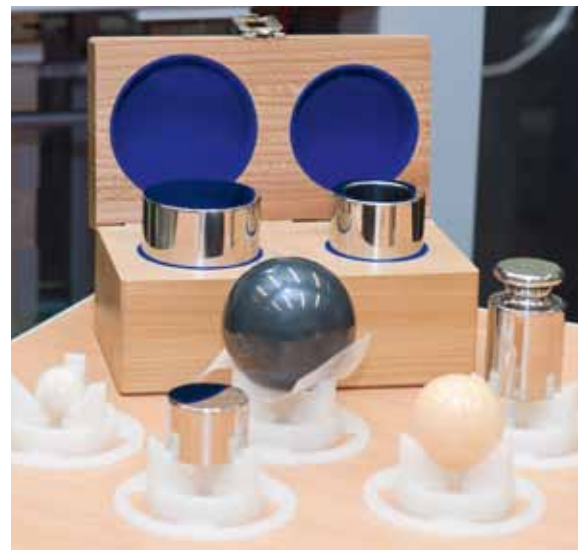
3 Verschiedene Referenzvolumen und Prüflinge: Die drei unterschiedlich grossen Kugeln im Vordergrund sind Arbeitsnormale, die vier Stahlkörper Prüflinge.
