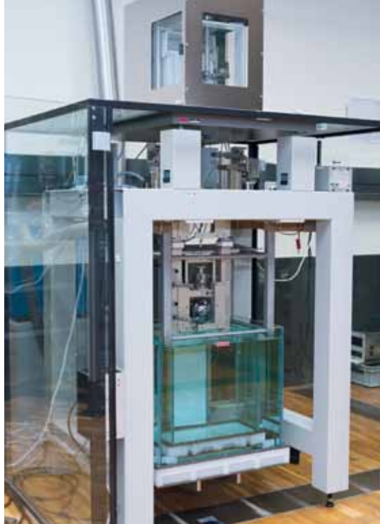
2 1-kg-Volumenkomparator des METAS: Der Prüfling – ein 1-Kilogramm-Knopfgewicht der OIML – und eine hoch präzise Referenz-Siliziumkugel werden in das Bad aus Reinstwasser abgesenkt und anschliessend abwechselungsweise gewogen. Die Dichte des Wassers wird mit dem Silizium-Volumennormal ermittelt und anschliessend das Volumen des Prüflings bestimmt.
