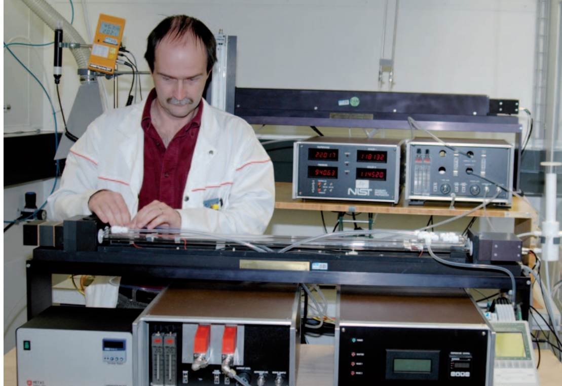
METAS betreibt zwei primäre Ultraviolett-Photometer, mit denen Transfernormale für Ozon kalibriert werden.
