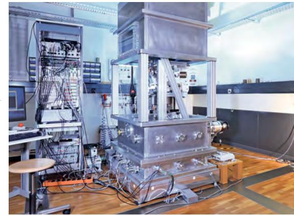
Erste Realisierung der Masse mit der Kibble-Waage.
