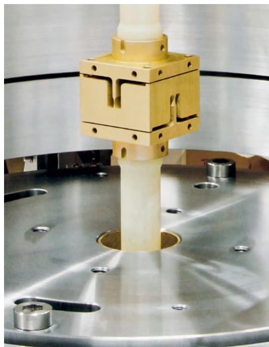
La suspension de la bobine est liée à la cellule de pesée par l'intermédiaire d'un cardan et un système de doubles cônes. Cette construction permet de séparer les forces latérales des couples.
